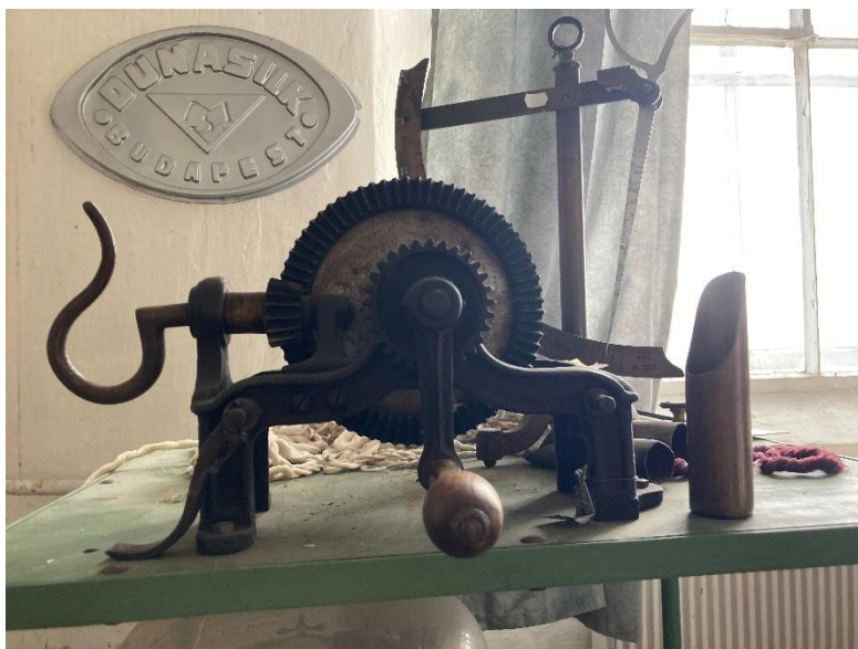
Besodró gép, mellette a 4 cm hosszú, ferdén vágott réz cső
